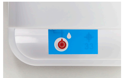
Zu geringes Probenvolumen aufgetragen.
