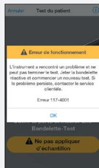
⚠ **Exemple d'un écran d'erreur :** Si le contrôle intégré (On Board Control, OBC) échoue, un message d'erreur s'affiche et aucun résultat de test n'est transmis. Suivre les instructions à l'écran pour jeter la Bandelette-test et commencer un nouveau test. Si le problème persiste, contacter le service client.
